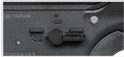
Предохранитель - Привод не будет стрелять
